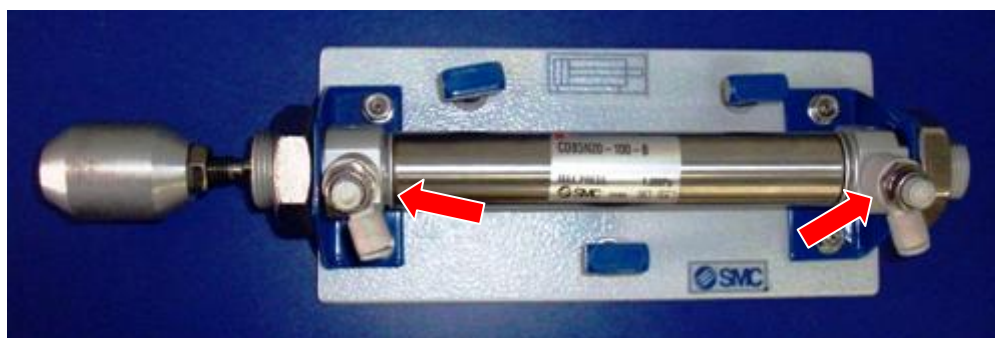
Figura 50: Cilindro com reguladores de vazão de ar
