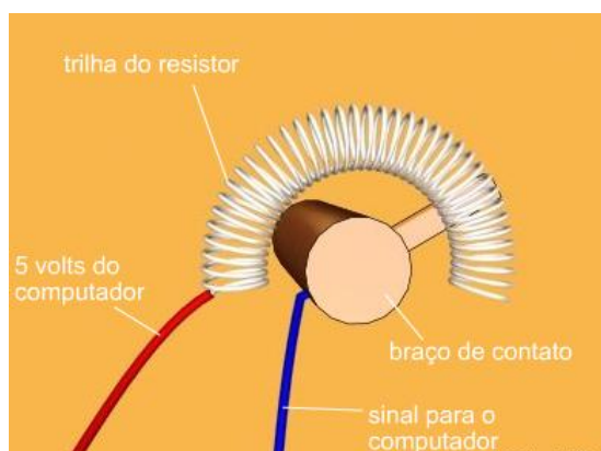
Figura 30: Potenciômetro Fonte: eletronicos.hsw.uol.com.br/joystick (2002)
