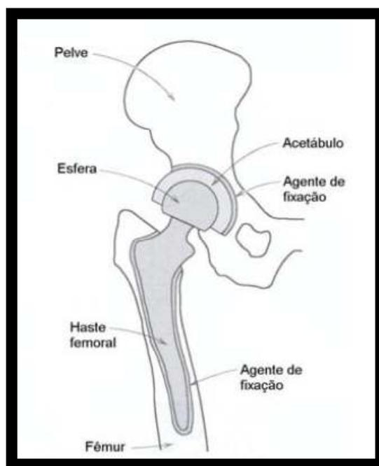
**Figura 18 - Diagrama esquemático de uma substituição artificial do quadril. O agente de fixação pode fazer parte do sistema, no caso de próteses cimentadas, ou não fazer parte do sistema, no caso de próteses sem cimento.**
