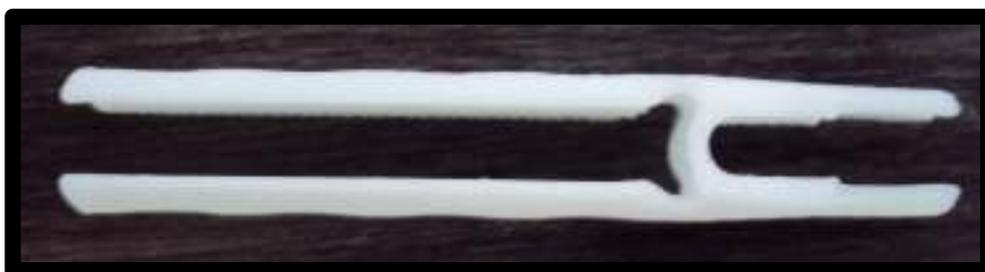
**Figura 55 - Clipador tipo Persuader - Protótipo rápido**
