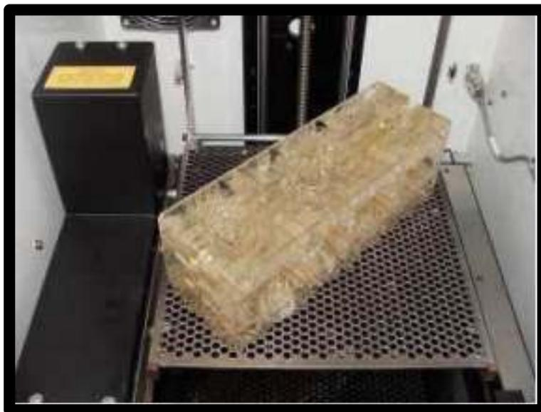
**Figura 9 - Caixa de machos sobre a plataforma do equipamento de estereolitografia**
