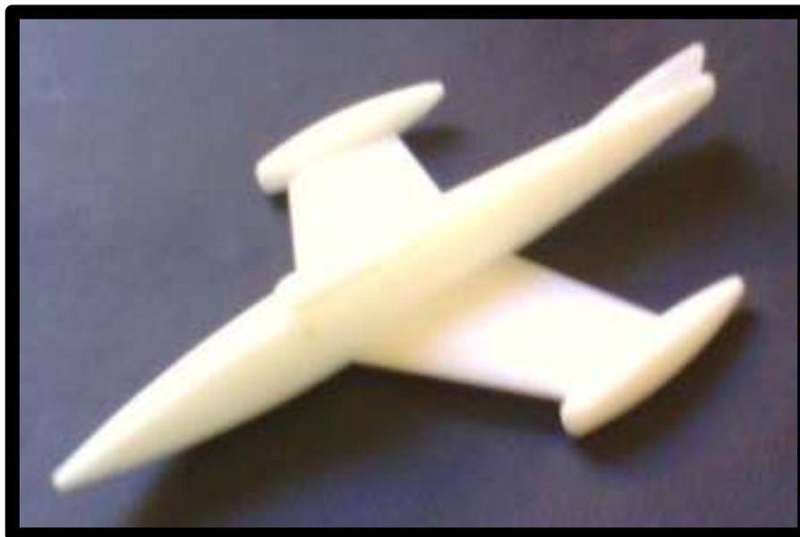
**Figura 8 - Protótipo rápido do aeromodelo utilizado na disciplina Laboratório de Fundição**
