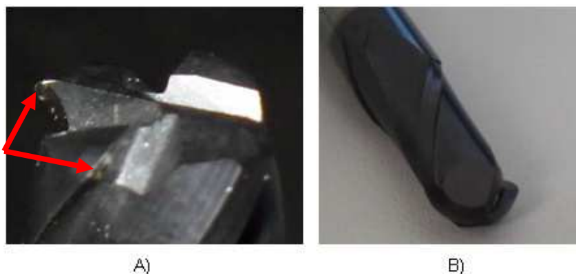
Figura 44: Ferramenta Metal Duro Inteiro: A) Toroidal_Ø8_R1 (CMR0810) utilizada no Redesbaste; B) Esférica_Ø8 (CLB 0802) utilizada no Semiacabamento.
