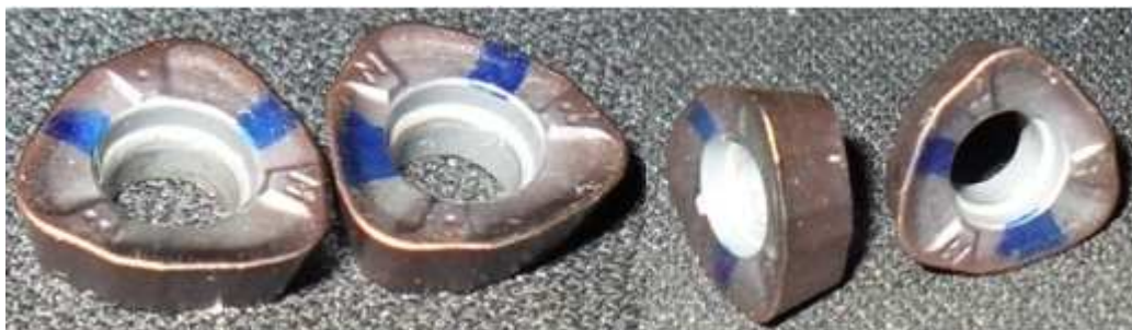
Figura 43: Inserto JOMT080320, classe VP15TF utilizado no desbaste.
