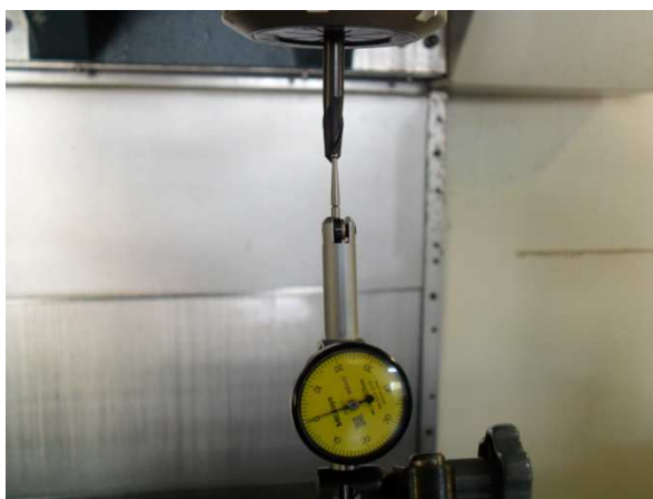
Figura 31: Medição de batimento radial, ferramentas de metal duro inteiriço.
