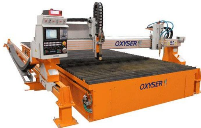
**Figura 2.9.:** Tábua de água e mufla de água.
