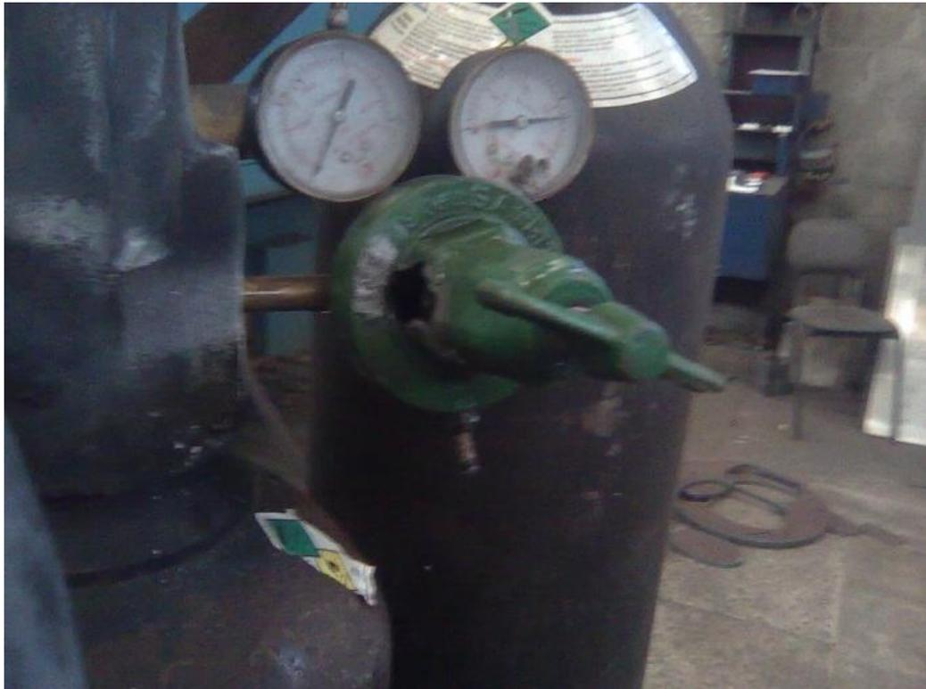
**Figura 3.1.:**Foto de um manômetro de oxigênio após sofrer uma explosão.
