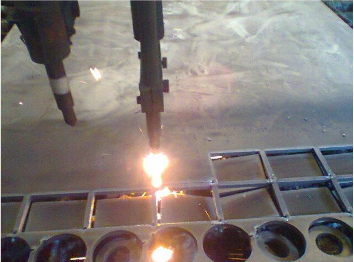
**Figura 4.6.:** Processo de corte por oxicorte.
