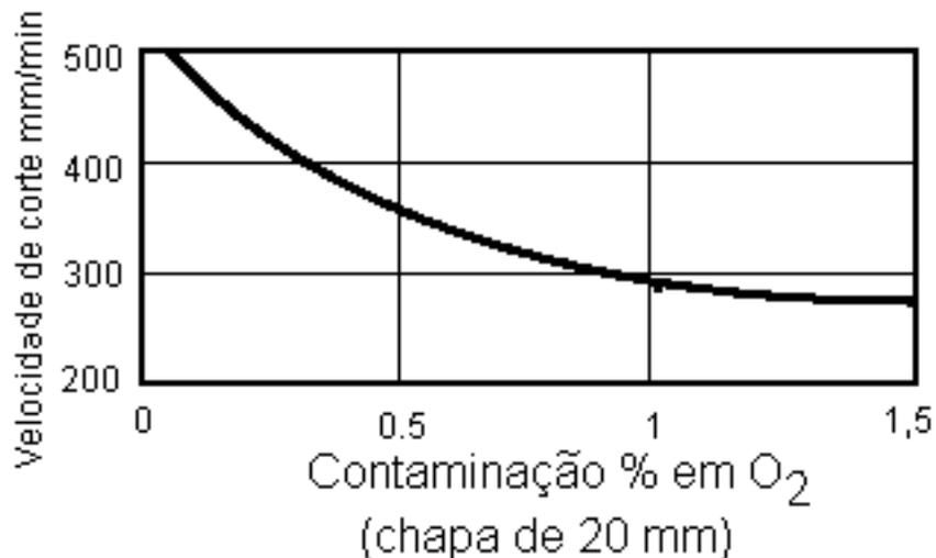
**Gráfico 3.3.:** Curva de variação da velocidade de corte em relação à pureza do Oxigênio em uma chapa de 20mm.
