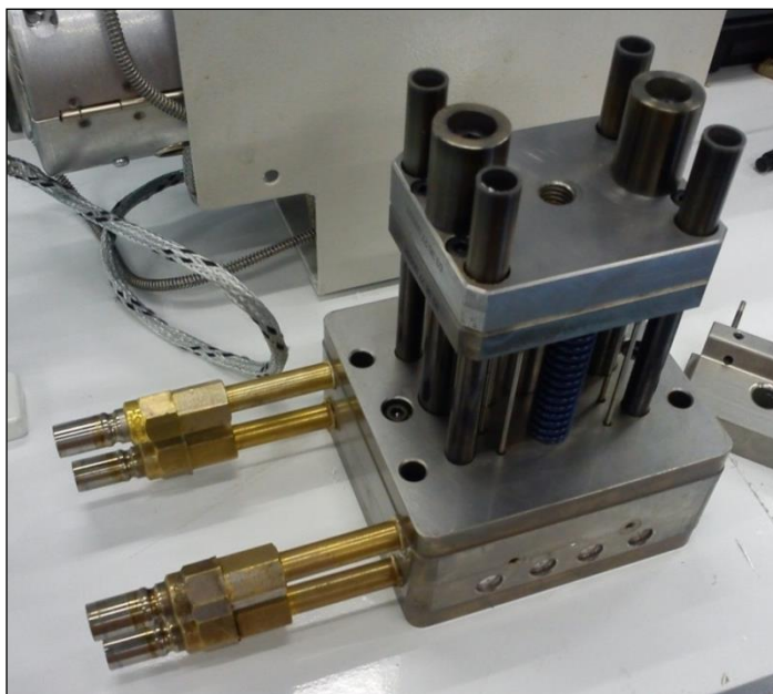
Figura 39: Molde de injeção completo
