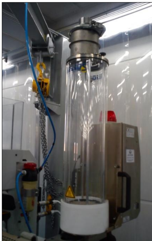
Figura 38: Pré-aquecimento da matéria-prima e dosagem da mesma no cilindro de injeção (funil)
