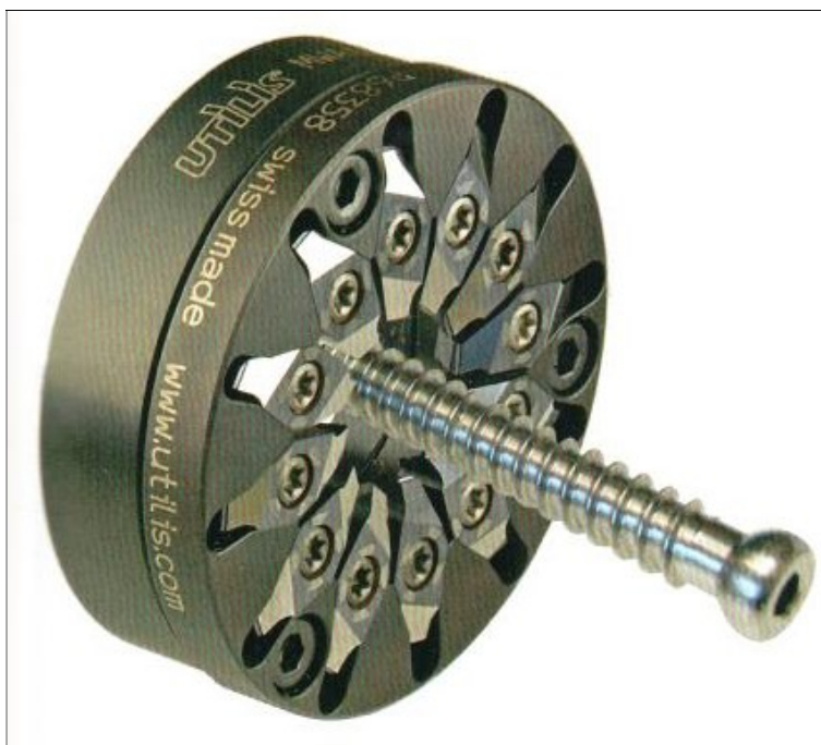
Figura 17: Turbilhonador usinando rosca do parafuso
