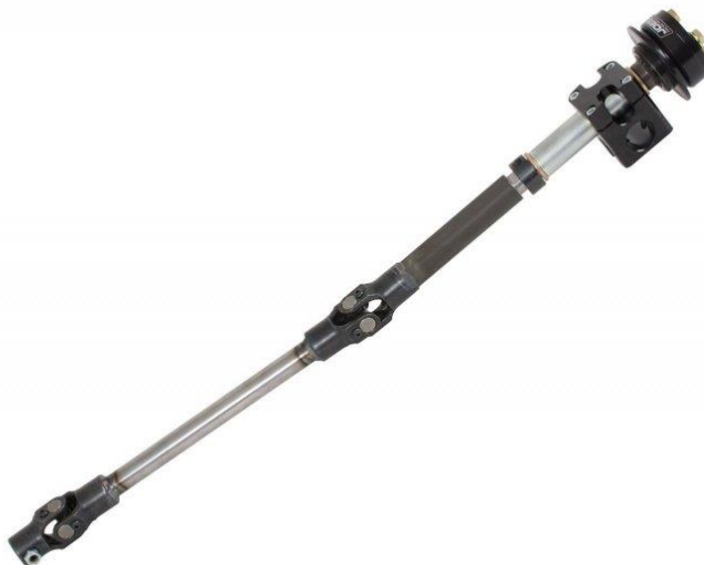
Figura 3: Componentes de uma coluna e árvore de direção juntas.
