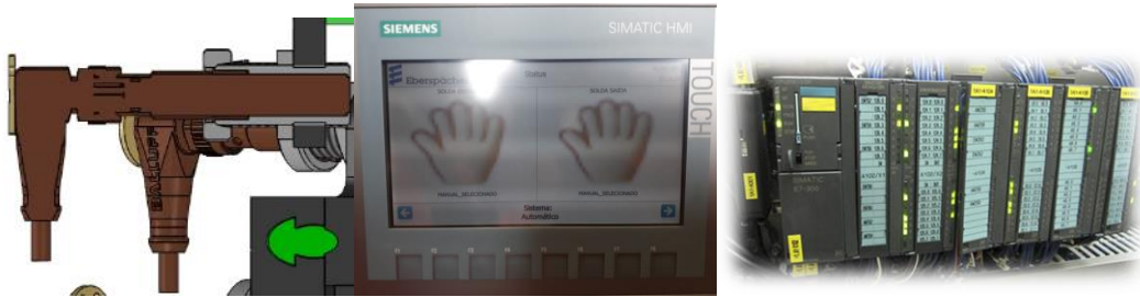
Figura 14 – Elementos elétricos (sensor indutivo, IHM e CLP)
